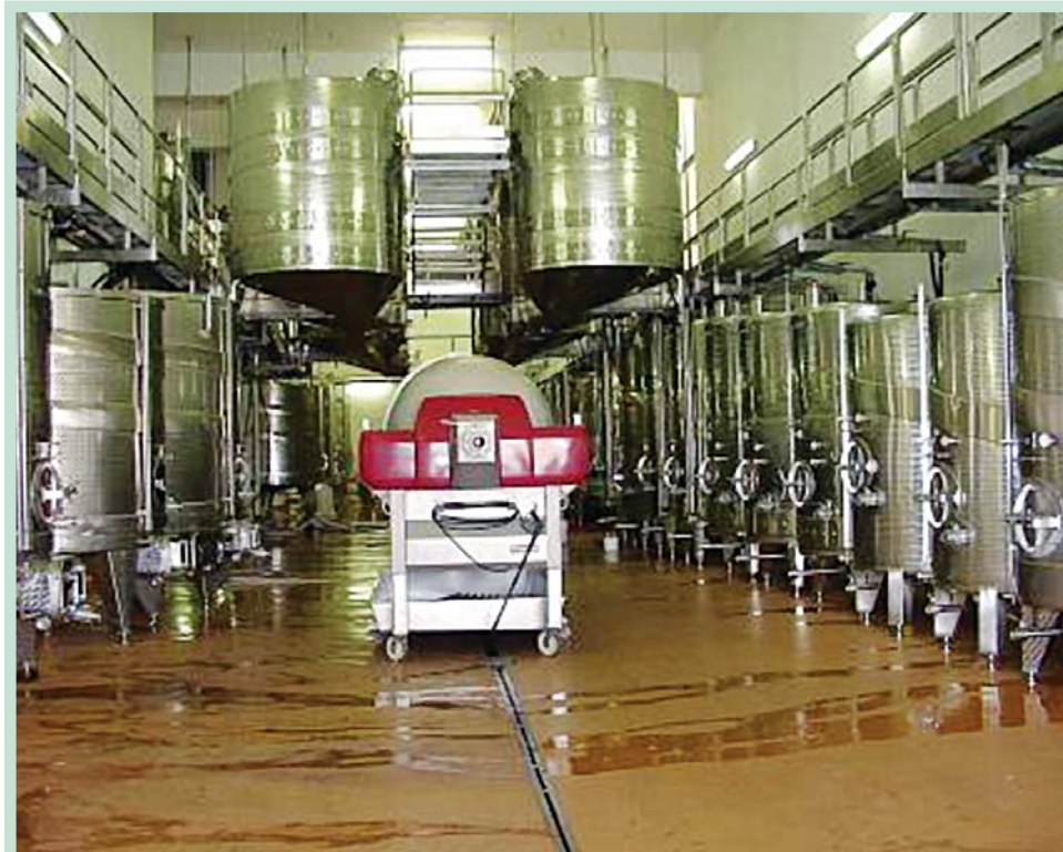
Fig. 62: Vin rouge: cuves de fermentation surélevées pour pouvoir remplir la presse sans pomper.
