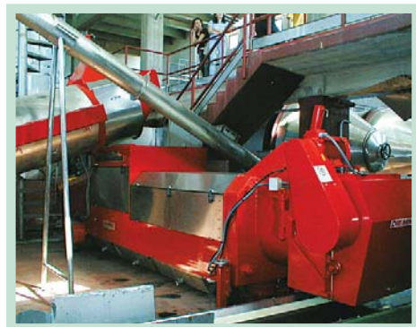
Fig. 71: Système de pressurage du marc de vin rouge.
