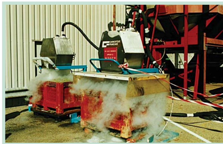
Fig. 64: Equipement technique pour macération à froid avec neige carbonique. Production de neige carbonique.
