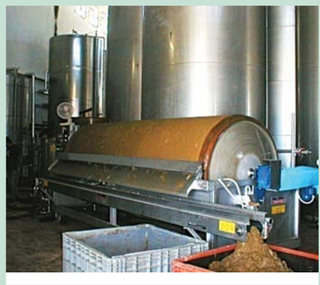
Fig. 45: Sur moûts: filtre-presse (gauche) et filtre rotatif sous vacuum (droite) avec cellulose, Kieselgur ou perlite
