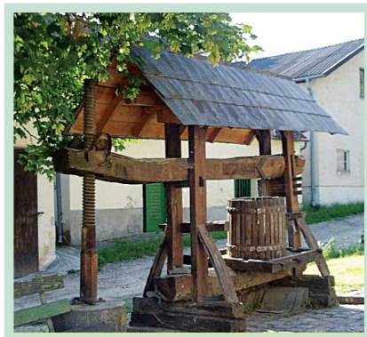
Fig. 39: Pressoir ancien à levier et cage verticale en bois
